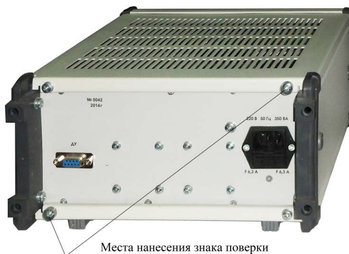
Рисунок 2 - Схема пломбировки от несанкционированного доступа и места нанесения знака поверки
